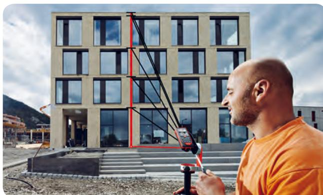
Tracciamento di altezze con il sensore di inclinazione
