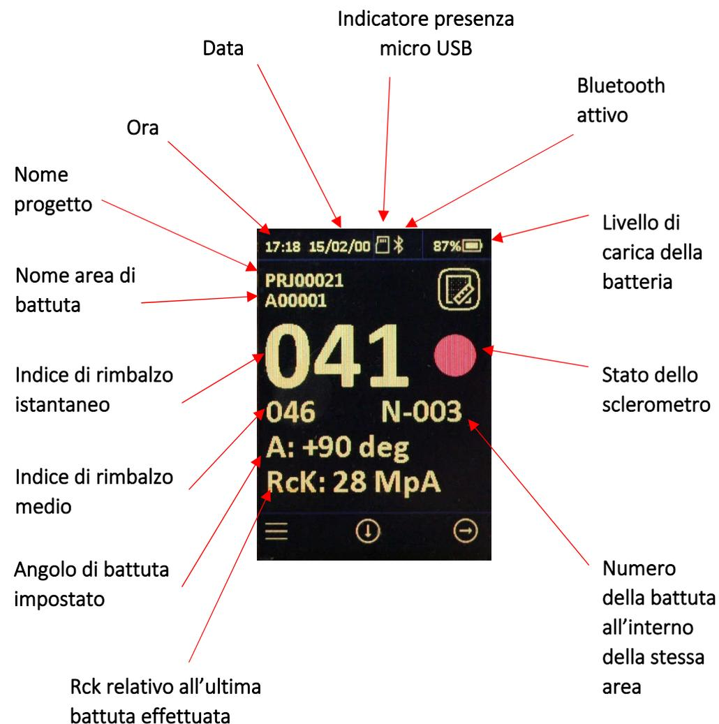
Una volta terminate le battute necessarie per l'area in oggetto, premere il pulsante 2; si entra in un menu in cui è possibile effettuare le seguenti scelte.
