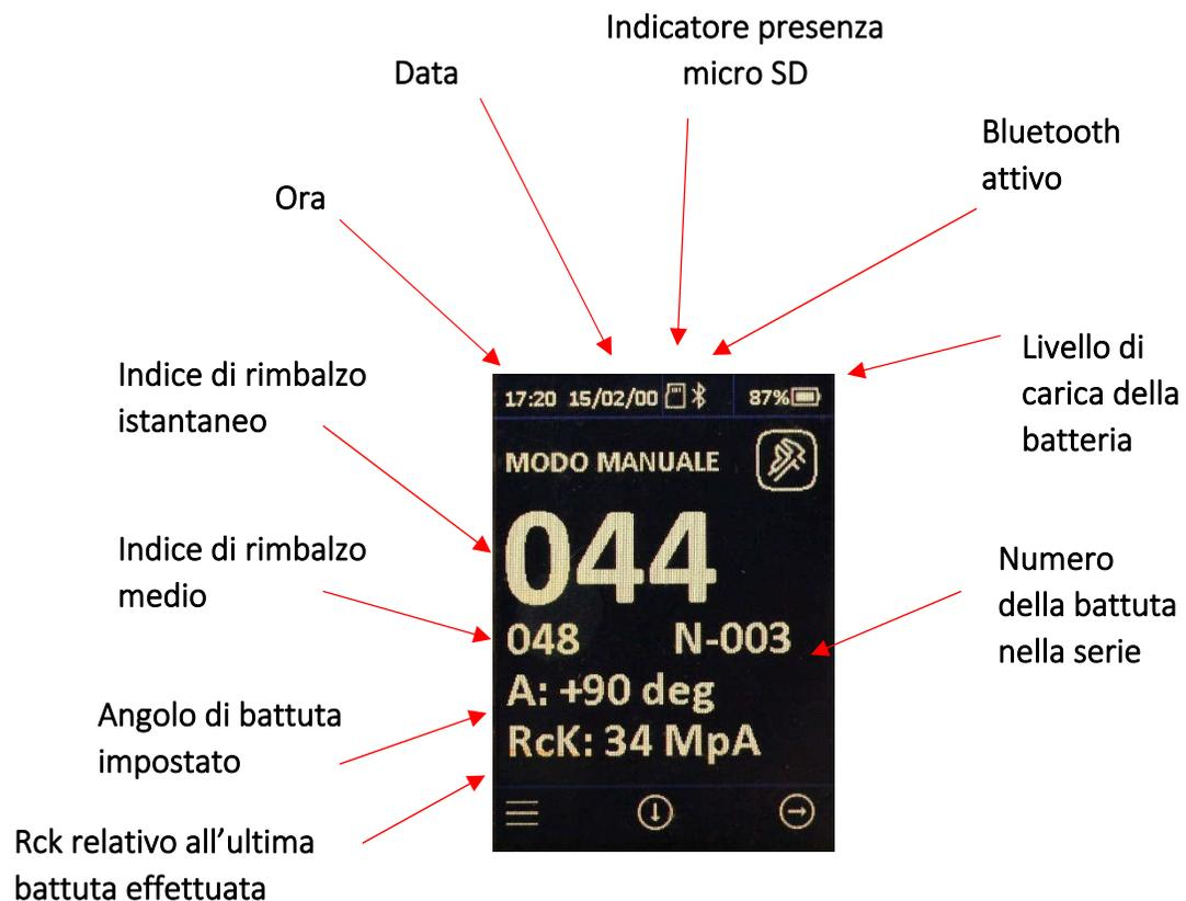
Una volta terminate le battute con il metodo manuale, è possibile premere il pulsante 2 per entrare nel menu in cui è possibile effettuare le seguenti scelte.
