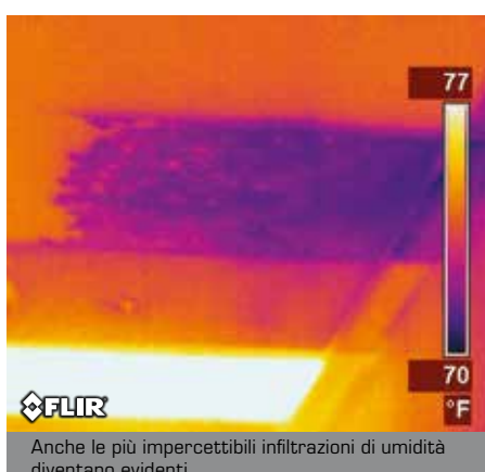
Infiltrazione di aria più fredda attraverso il davanzale della finestra.
