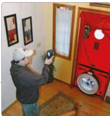
Indagine termica utilizzata per i test "blower door" accentua lo schema della perdita di aria e altri aspetti di efficienza energetica.
