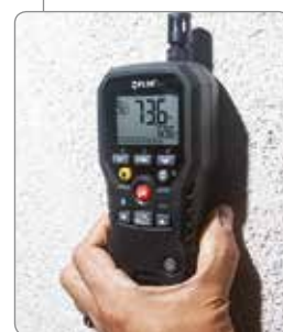
FLIR MR77 dispone di un sensore di umidità senza puntali e di una sonda con puntale cablato.
