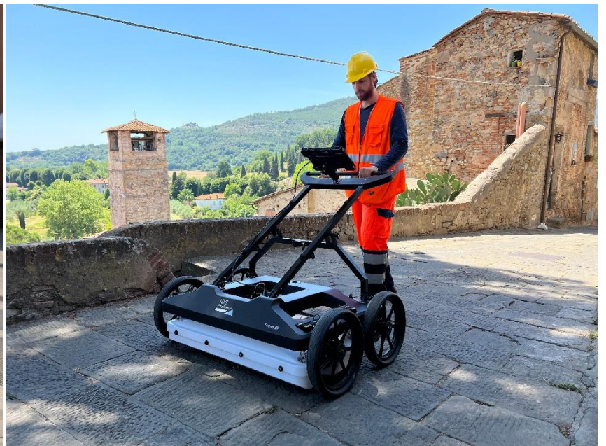
Configurazione per indagini su superfici sconnesse, 4 ruote di grossa dimensione.
