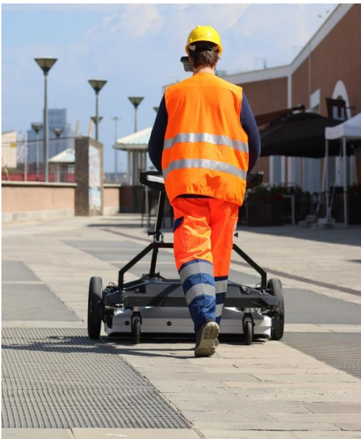
Configurazione per indagini su superfici piane, ruote posteriori pivotanti.
