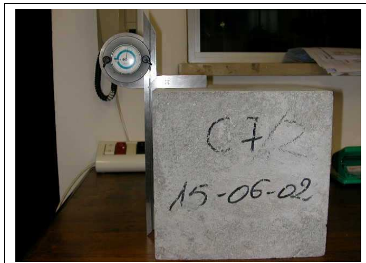
Foto n° 3 – Controllo della complanarità delle facce del provino
